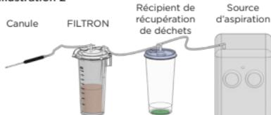
Le système FILTRON est placé dans le circuit entre la poignée de la canule et le récipient de récupération de déchets
