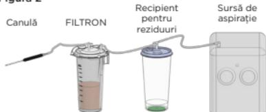
FILTRON este amplasat în linie. Între mânerele canulei și recipientul pentru reziduri
