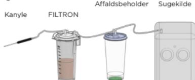
FILTRON er placeret på linjen mellem kanyle-håndtaget og affaldsbeholderen
