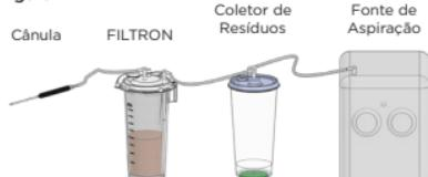
O FILTRON é colocado em linha entre a pega da cânula e o coletor de resíduos
