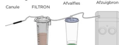
De FILTRON wordt in lijn geplaatst tussen het handvat van de canule en de afvalfles
